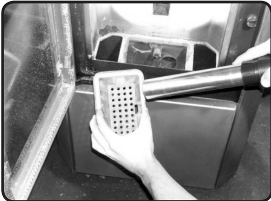
Abb. 14b: Reinigung der Luftöffnungen mit einem Staubsauger
