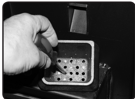
Abb. 14c: Reinigung der Luftöffnungen mit einem Werkzeug
