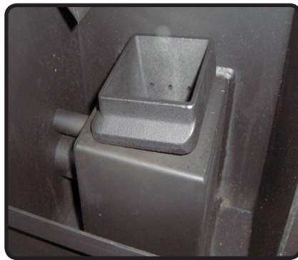
Abb. 8b: Falsch eingesetzter Brenntopf
